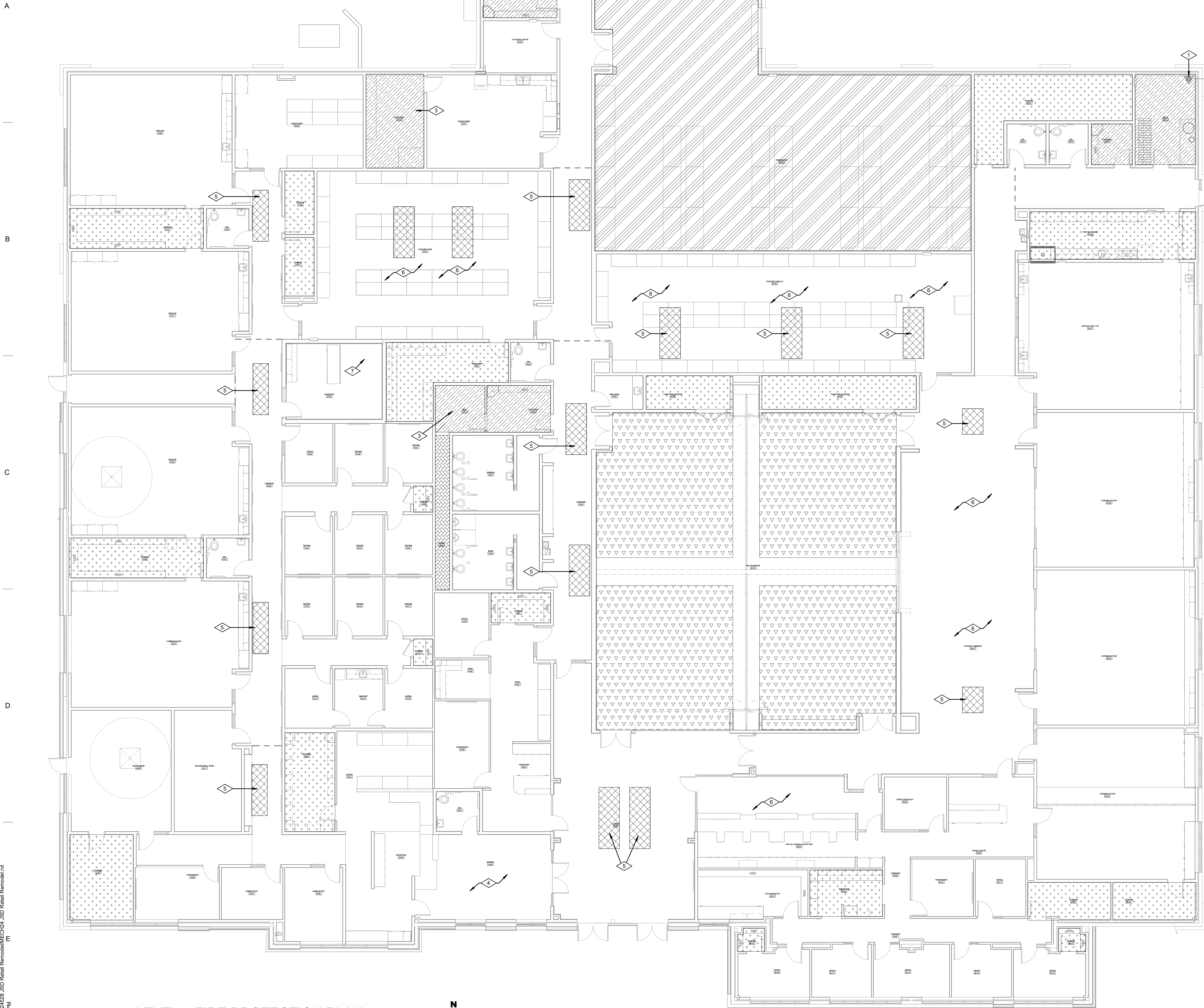
1 LEVEL 1 FIRE PROTECTION PLAN SCALE: 1/8" = 1'-0"
